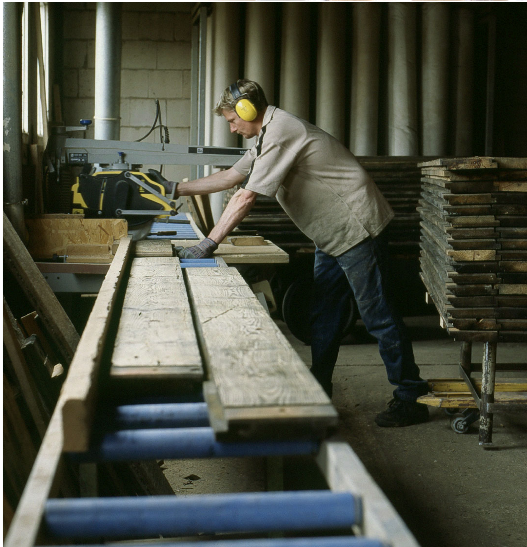
Nadat de ruwe planken van eventuele spijkers zijn ontdaan, volgt een aantal bewerkingen met moderne machines. Zo worden de planken door een vandiktebank gehaald en met een afkortaag op lengte gemaakt. Daarna worden de planken geschuurd of geborsteld.
